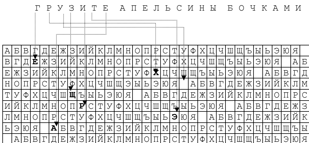
Рисунок 5. Принцип шифрования по таблице Виженера
